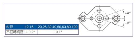
2、请严格遵守气缸固定板回转力矩的限制要求,超出限制范围的使用会造成气缸的损坏或使用寿命的缩短:
