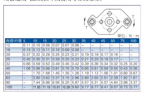
3、请严格遵守气缸固定板上横向负载的限制范围,超出限制范围的 使用会造成气缸的损坏或使用寿命的缩短;
